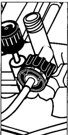
**Paso 2** Ajuste el extremo con filtro del tubo de detergente para cobertura ligera (-) o máxima (+)
