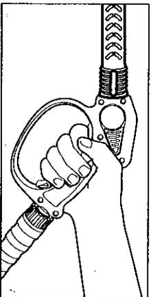
**Paso 4** Con el motor en marcha, oprima el gatillo de la pistola para hacer funcionar la máquina: el detergente líquido es aspirado hacia la máquina y se mezcla con el agua. Aplique el detergente al área de trabajo. No permita que el detergente se seque sobre la superficie.
