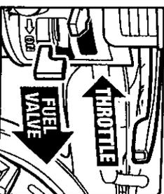
**Paso 6** Mueva la válvula de combustible a la posición de "encendido" (on). Mueva la palanca del acelerador a la izquierda, 1/3 de la distancia a la posición de "rápido" (fast).
