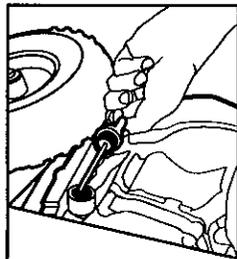
**Paso 1** Revise el nivel del aceite, el cual debe estar a nivel del fondo del cuello de llenado. Cuando revise el nivel de aceite, asegúrese que la máquina esté nivelada. (Refiérase al manual de operación de la máquina para ver los grados de acuerdo con las estaciones del año.) Recomendamos cambiar el aceite después de las primeras cinco horas de uso y posteriormente cada 50 horas. Nota: Los niveles de aceite no adecuados provocarán que el sensor apague el motor.
