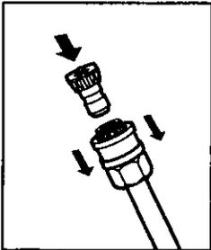
**Paso 5** Jale del collar accionado por resorte de la lanza hacia atrás, para insertarlo en la boquilla de conexión rápida de su elección.
