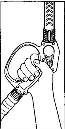
**Étape 4** Une fois le moteur en marche, pressez la gâchette pour faire fonctionner l'appareil : le détergent liquide est dirigé dans le module et est mélangé à l'eau. Appliquez le détergent sur la surface à nettoyer. Ne pas laisser sécher.
