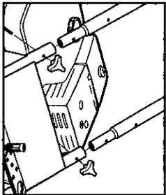
**Étape1** Fixez le manche au châssis du Nettoyeur à pression. Alignez les trous, insérez les boulons et serrez avec les boutons.
