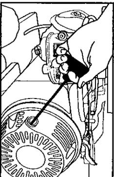
**Paso 8** Jale de la manija del arrancador. Si la máquina no enciende después de tres tirones, apriete el gatillo de la pistola para eliminar la presión y repita este paso. Después uniformemente, mueva la palanca del ahogador a la derecha, a "abierto" (open) y el acelerador a la izquierda a "rápido" (fast).
