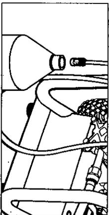
**Paso 3** Llene el recipiente con detergente Kärcher. Coloque el extremo con filtro del tubo de succión de detergente dentro del recipiente.
