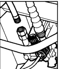
**Étape9** Fixez le boyau d'arrosage à la prise d'eau de l'appareil.
