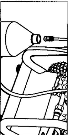
**Étape 3** Remplissez un contenant avec le détergent Kärcher. Insérez le bout filtre du tube de succion de détergent dans le détergent.
