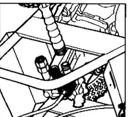
**Paso 7** Desconecte la manguera de alta presión de la salida de alta presión.
