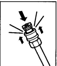
**Étape6** Relâchez la bague et poussez la buse jusqu'à ce que la bague s'enclenche. Tirez sur la buse pour vérifier qu'elle est bien en place.
