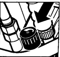
**Paso 9** Ajuste el control de presión a la posición deseada.
