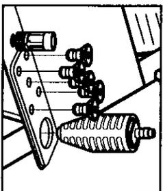
**Paso 3** Coloque las boquillas de conexión rápida en el soporte de boquillas.
