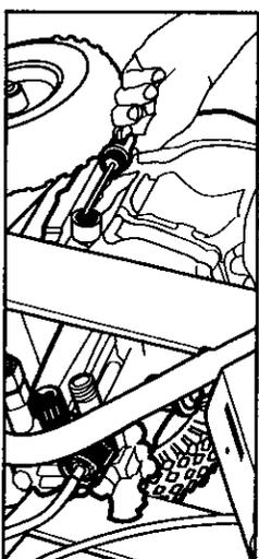
**Étape 1** Vérifiez le niveau d'huile qui doit être à égalité avec le fond du col de remplissage d'huile. Assurez-vous que l'appareil est de niveau lorsque vous vérifiez l'huile. (Voir le manuel d'utilisation pour les calibres saisonniers.) Nous recommandons d'effectuer un changement d'huile après les 5 premières heures d'utilisation, puis à toutes les 50 heures.
