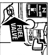
**Paso 2** Nueve la válvula del combustible a la posición de "apagado" (off).
