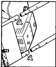
**Paso 1** Fije la agarradera con los postes de la lavadora a presión. Alinee los orificios, inserte los tornillos y apriételos con las perillas.
