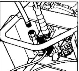
**Paso 6** Desconecte la manguera de jardín de la entrada de agua de la máquina.
