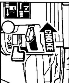
**Paso 5** Mueva la palanca del ahogador a la izquierda a la posición de "cerrado" (closed) (si la máquina está caliente, deje la palanca en la posición de "abierto" (open)).
