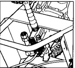
**Étape 7** Desconecte la manguera de alta presión de la salida de alta presión.
