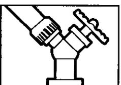
**Étape 3** Fixez le boyau d'arrosage au robinet d'eau froide et l'ouvrir à pleine capacité. **Né jamais utiliser d'eau chaude.**
