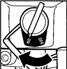
**Paso 7** Gire el interruptor de la máquina a la posición de "encendido" (on).
