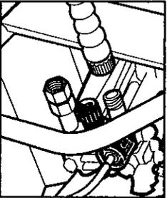
**Paso 8** Conecte la manguera de alta presión a la salida de la unidad de alta presión.
