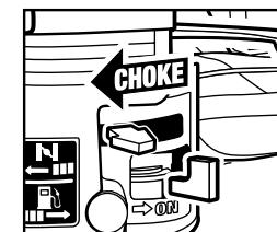
**Étape 5** Glissez le levier d'étrangleur vers la gauche à la position fermée (« closed »). (Si le moteur est chaud, laissez le levier à la position ouverte (« open »).
