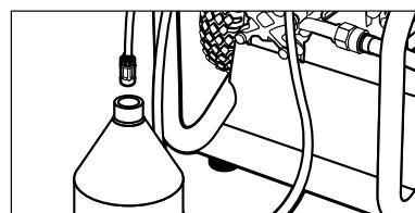
**Étape 3** Remplissez un contenant avec le détergent Kärcher. Insérez le bout filtre du tube de succion de détergent dans le détergent.
