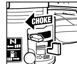
**Paso 5** Mueva la palanca del ahogador a la izquierda a la posición de "cerrado" (closed) (si la máquina está caliente, deje la palanca en la posición de "abierto" (open)).
