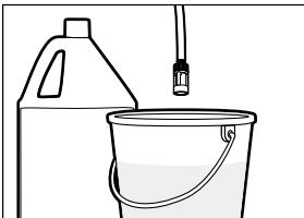
**Étape 1** Retirez etirez le tube de succion de détergent du contenant et le placer dans un contenant de 3,78 litres d'eau fraîche. À basse pression, siphonnez l'eau durant une minute.
