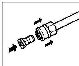
**Paso 6** Jale del collar accionado por resorte de la lanza hacia atrás, para insertarlo en la boquilla de conexión rápida de su elección.
