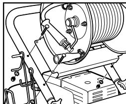
**Paso 3** Fije el carrete al asa. Alinee los orificios, inserte los pernos y apriete con las tuercas.
