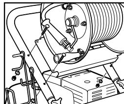
**Étape 3** Fixer le tuyau dans le manche. Aligner les trous, insérer les boulons et serrer avec les écrous.
