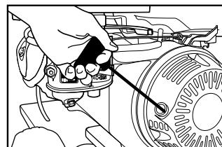
**Paso 8** Jale de la manija del arrancador. Si la máquina no enciende después de tres tiros, apriete el gatillo de la pistola para eliminar la presión y repita este paso. Después que la máquina se caliente y funcione uniformemente, mueva la palanca del ahogador a la derecha, a "abierto" (open) y el acelerador a la izquierda a "rápido" (fast).
