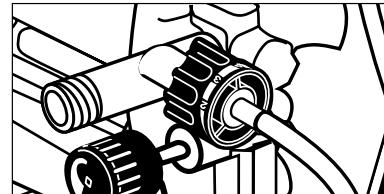
**Paso 2** Ajuste el extremo con filtro del tubo de detergente para cobertura ligera (-) o máxima (+).
