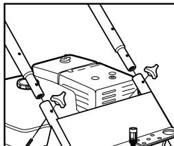
**Étape 1** Fixez le manche au châssis du Nettoyeur à pression. Alignez les trous, insérez les boulons et serrez avec les boutons.
