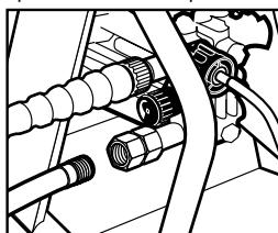
**Étape 10** Fixez le boyau d'arrosage à la prise d'eau de l'appareil.
