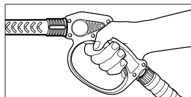
**Étape 4** Une fois le moteur en marche, pressez la gâchette pour faire fonctionner l'appareil : le détergent liquide est dirigé dans le module et est mélangé à l'eau. Appliquez le détergent sur la surface à nettoyer. Ne pas laisser sécher.
