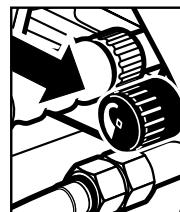
**Étape 9** Ajustez le contrôle de la pression à la position désirée.
