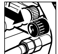
**Paso 9** Ajuste el control de presión a la posición deseada.
