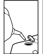
**Paso 2** Llene el tanque de gasolina con gasolina sin plomo. No utilice gasolina con plomo.
