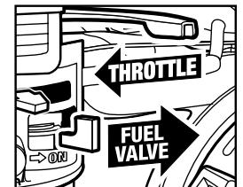
**Paso 6** Mueva la válvula de combustible a la posición de "encendido" (on). Mueva la palanca del acelerador a la izquierda, 1/3 de la distancia a la posición de "rápido" (fast).
