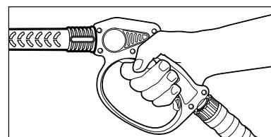
**Paso 4** Con el motor en marcha, oprima el gatillo de la pistola para hacer funcionar la máquina: el detergente líquido es aspirado hacia la máquina y se mezcla con el agua. Aplique el detergente al área de trabajo. No permita que el detergente se seque sobre la superficie.
