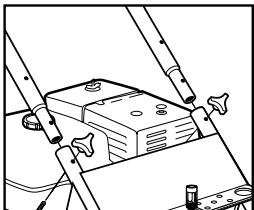
**Paso 1** Fije la agarradera con los postes de la lavadora a presión. Alinee los orificios, inserte los tornillos y apriételos con las perillas.
