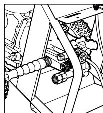
**Paso 7** Desconecte la manguera de alta presión de la salida de alta presión.
