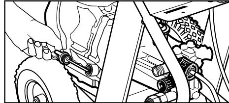
**Paso 1** Revise el nivel del aceite, el cual debe estar a nivel del fondo del cuello de llenado. Cuando revise el nivel de aceite, asegúrese que la máquina esté nivelada. (Refiérase al manual de operación de la máquina para ver los grados, de acuerdo con las estaciones del año.) Recomendamos cambiar el aceite después de las primeras cinco horas de uso y posteriormente cada 50 horas. **Nota:** Los niveles de aceite no adecuados provocarán que el sensor apague el motor.
