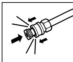
**Étape 7** Relâchez la bague et poussez la buse jusqu'à ce que la bague s'enclenche. Tirez sur la buse pour vérifier qu'elle est bien en place.
