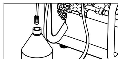
**Paso 3** Llene el recipiente con detergente Kärcher. Coloque el extremo con filtro del tubo de succión de detergente dentro del recipiente.
