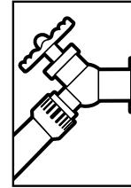
**Étape 3** Fixez le boyau d'arrosage au robinet d'eau froide et l'ouvrir à pleine capacité.
