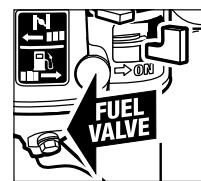
**Paso 2** Mueva la válvula del combustible a la posición de "apagado" (off).
