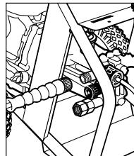
**Étape 7** Retirez le boyau à haute pression de la sortie haute pression du module.
