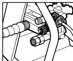
**Étape 9** Fixez le boyau haute pression à la sortie haute pression de l'appareil.
