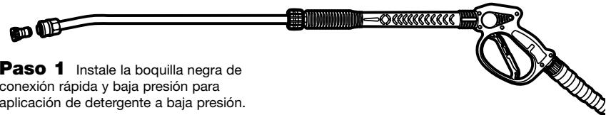
**Paso 1** Instale la boquilla negra de conexión rápida y baja presión para aplicación de detergente a baja presión.
