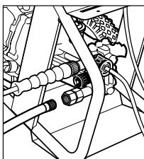
**Paso 6** Desconecte la manguera de jardín de la entrada de agua de la máquina.
