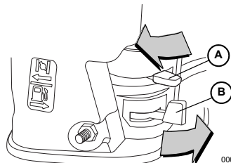
Figura 3-2. Válvula de combustible y cebador
