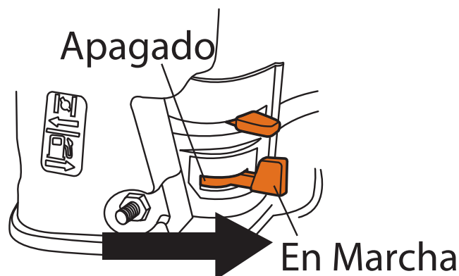
Figura 21 - Válvula de combustible
