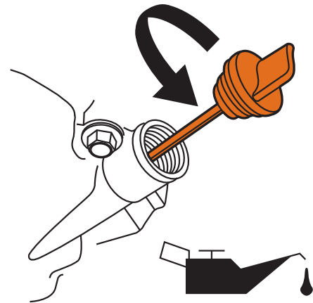
Figure 31 - Remplir l'huile à moteur
