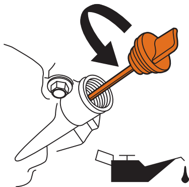
Figura 36 – Llenado de aceite del motor
