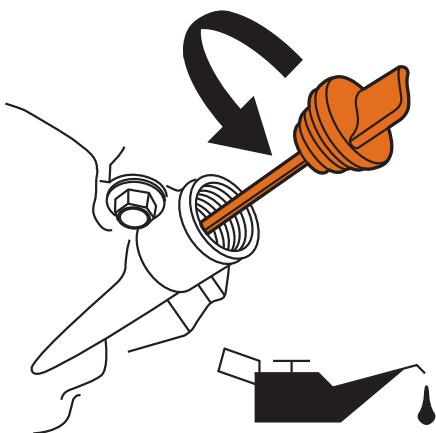
Figure 6 - Remplir l'huile à moteur
