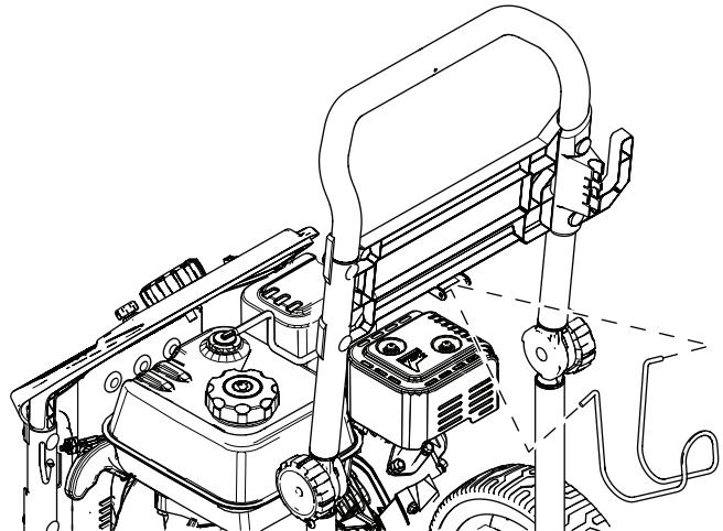
5. Insérez les buses à code couleur dans les espaces appropriés se trouvant dans le panneau avant (figure 6).
