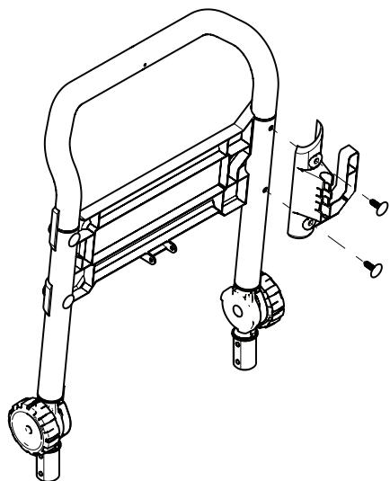
2. Instale el gancho para la lanza en el bastidor de la unidad usando (2) broches de fijación escalonados suministrados. Alinee los agujeros y empuje los broches de fijación escalonados hasta que asienten a ras con el gancho para lanza (Figura 3).
