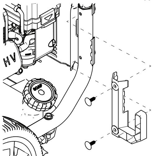
3. Placez l'ensemble de la poignée (A) sur les supports arqués (B). Laissez la poignée glisser en place. Prenez les (4) vis et la clé hexagonale. Installez les quatre vis, comme illustré, au moyen de la clé hexagonale fournie (figure 4).
