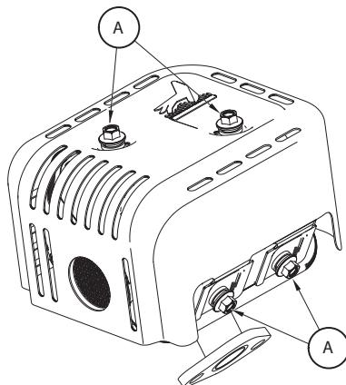
*Figura 44 - Retiro del supresor de chispas*
