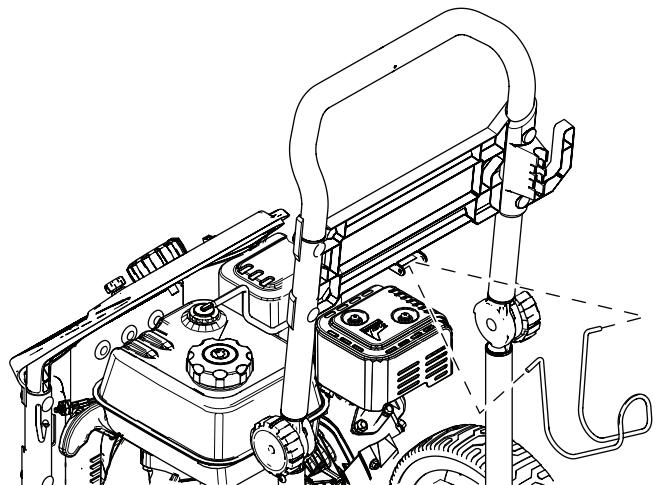
5. Inserte las boquillas con código de color en los espacios provistos en el panel delantero (Figura 6).
