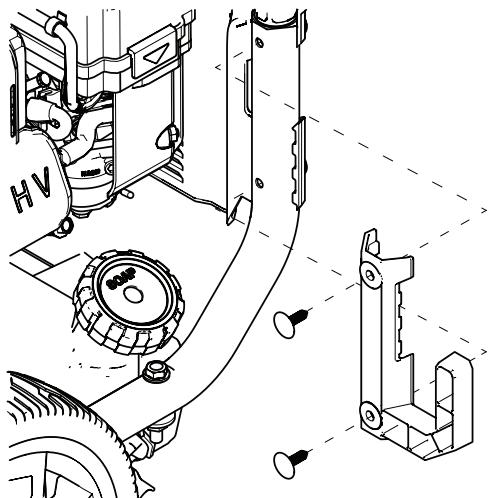
3. Coloque el conjunto de asa (A) en los soportes del carro (B). Permita que el asa se desplace a su posición. Ubique los tornillos (4) y la llave Allen. Instale los cuatro tornillos usando la llave Allen suministrada (que se muestra en la Figura 4).
