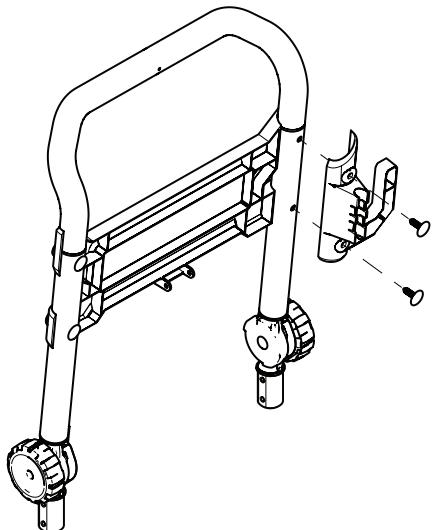
2. Installez le crochet de la lance au châssis de l'appareil à l'aide des (2) pinces à coulisses fournies. Alignez les trous et insérez les pinces à coulisse dans les trous jusqu'à ce qu'elles soient au même niveau que le crochet du pistolet (figure 3).
