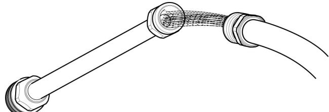
7. Vuelva a instalar la boquilla en la lanza.
