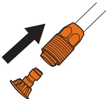
**Figure 18 – Buse à pression de lavage (verte)**
