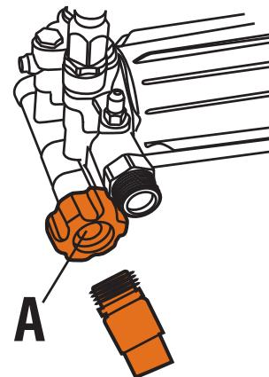
3. Raccordez le boyau d'arrosage (sa longueur ne doit pas dépasser 50 pieds [15,24 mètres]) à la prise d'eau (figure 12). Serrez à la main.
