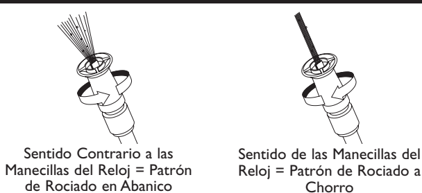
Figura 36 — Ajustar el Patrón de Aspersión
